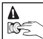
**KENNTNISSE, WO UND WIE DAS GERÄT IN EINEM NOTFALL AUSGESCHALTET WIRD.**
